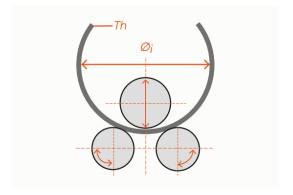
Le roulage doit être effectué dans les conditions suivantes : ØI ≥ 40 e (température de la pièce ≥ 10 ° C - 50° F)
